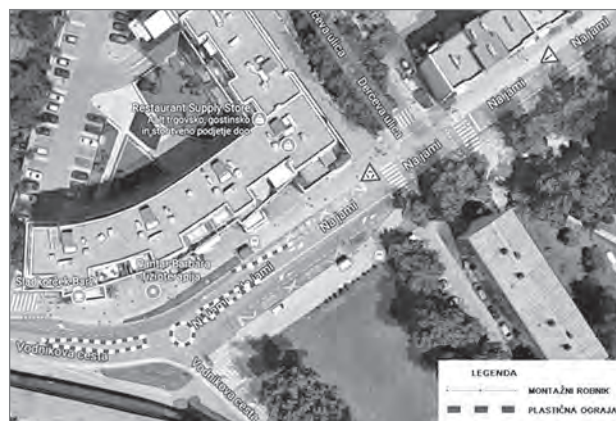
Slika 12: Prikaz postavitev montažnih vodilnih robnikov, plastičnih ograj in potrebne signalizacije zaradi začasnega krožišča (ilustracija: Urban Bračko)
